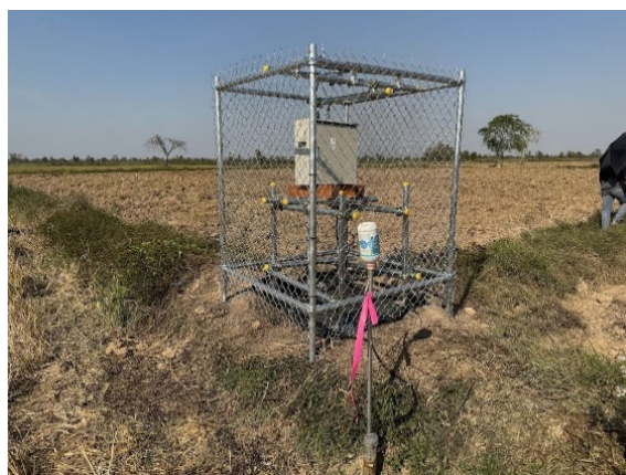
図 3 水位の遠方監視システム（RB3） Remote monitoring system for water level
